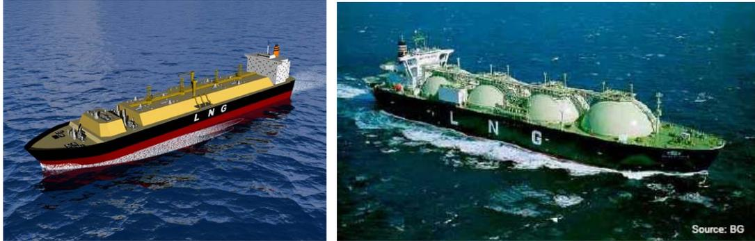
**Fig. 4 - Forma típica de buques metaneros “tipo membrana” (izq.) y Moss (der.)**
