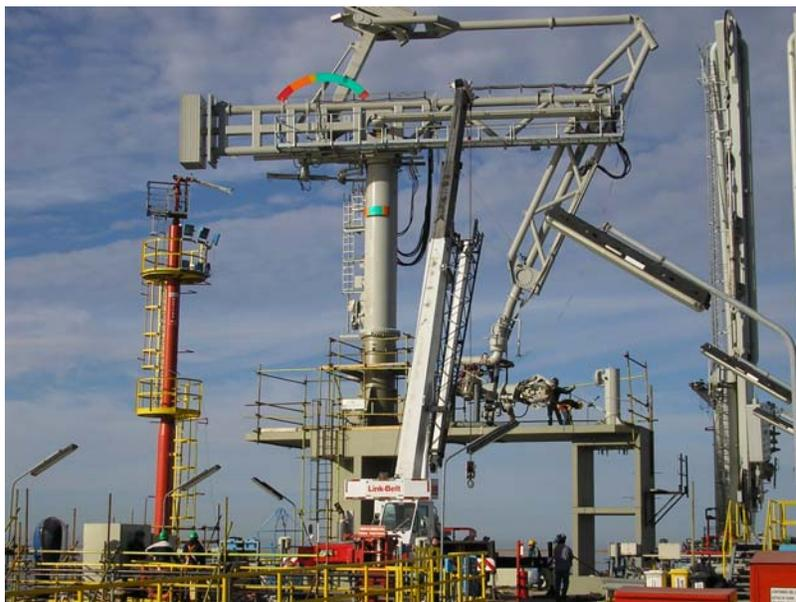
**Fig. 57 – Brazo de descarga de gas natural a presión**
