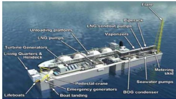
Fig. 14 - Regasificación *offshore*. Plataforma GBS.
