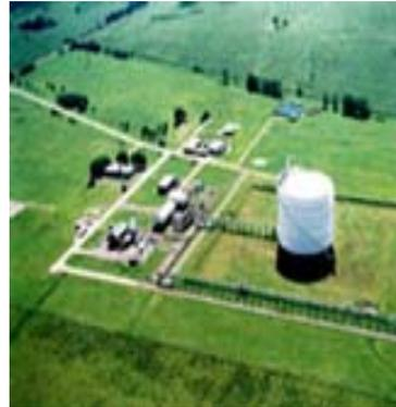
La Unidad de Vaporización y Emisión entra en funcionamiento cuando la demanda así lo requiere, para inyectar el gas en la red de distribución de Gas Natural
