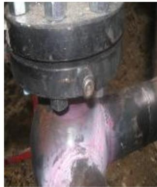
Esferica soldada para derivación. Ver prueba de tintas penetrantes.
