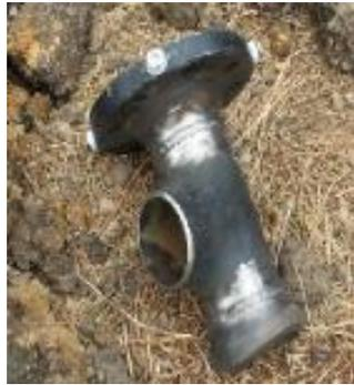
Soldadura de weldolet, tee y brida = 3 way tee.
